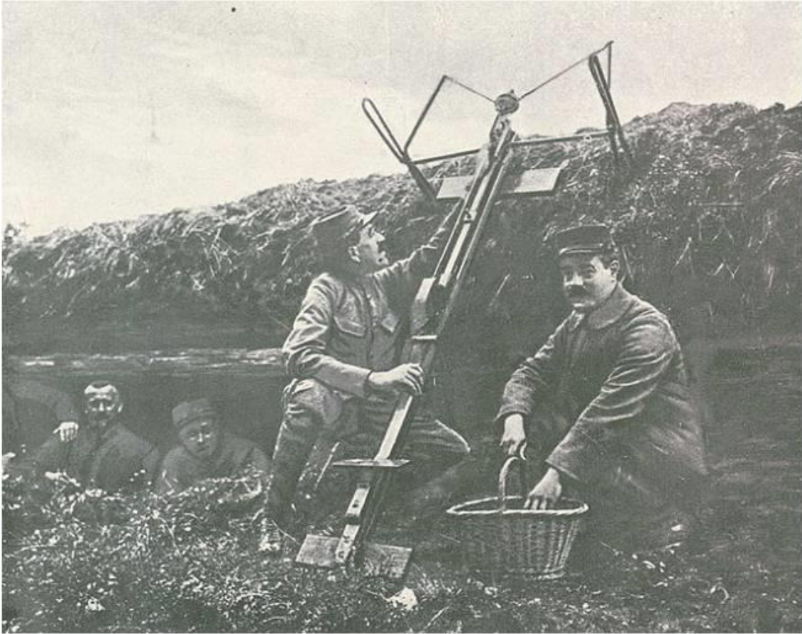
Ilustração Portuguesa. Um típico lança-granadas francês improvisado do começo da guerra. Parece uma catapulta medieval, onde um sistema de elásticos (podiam ser molas metálicas) projecta uma granada a centenas de metros. Era o antepassado directo do morteiro de trincheira.
